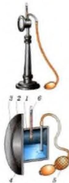
Рис. 23. Внешний вид и устройство конденсационного гигрометра
